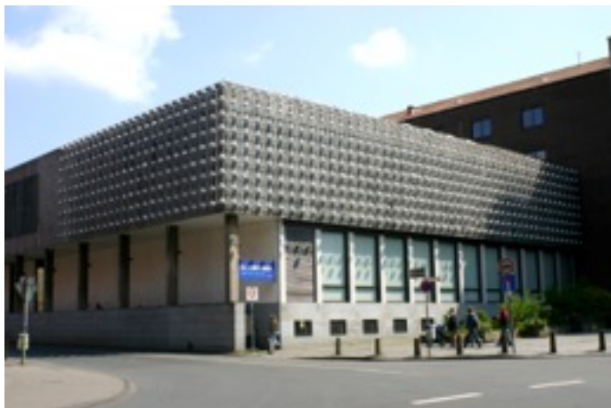
Silberne Frequenz, Otto Piene, 1970/1971, Westfälisches Landesmuseum, Münster Technik: Stahlrohrgitter, Aluminiumkugeln, Glühbirnen, programmierte Elektro-Schaltung
